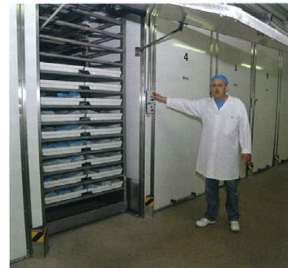
Moderne Klimaschränke „automatisieren“ das termingerechte Auftauen der Rohware und sind zudem umweltfreundlich, weil den Wasserbedarf um die Hälfte reduzieren.
